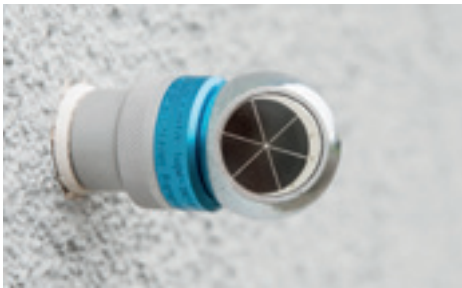
Kugelprismen-Monitoring-System mit M8-Gewindeanschluss zur Befestigung in Wandbolzen.
