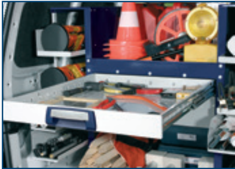
Detailansicht der kugelgelagerten Schubladen mit einer Belastbarkeit von 60 kg. Die zum Standard-Lieferumfang gehörende Schreibplatte wurde im Foto weggelassen.
