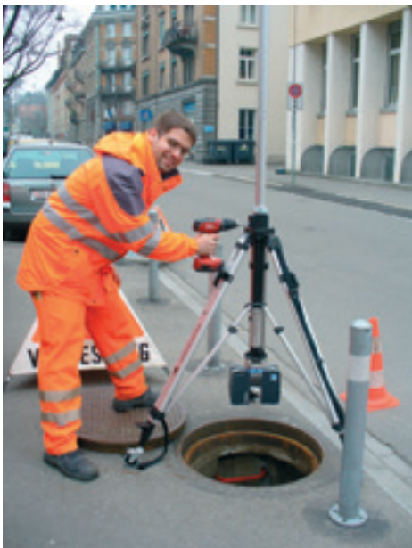
22-210 710 mit optionalen Stativrollen und Faro-Scanner kurz vor dem Absenken des Scanners mit einem Akkuschauber (nicht im Lieferumfang).
