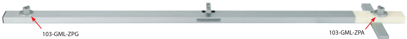
Mit dem beweglichen Prismenhalter auch die Spurweite messen. Die exakte Führung im isolierten Teil ist leider aufwändig und entsprechend teuer.
