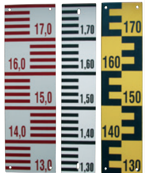
Hier sehen Sie die bei feuereemaillierten Pegellatten lieferbaren Teilungen und Farben, die Sie nach Ihren Wünschen kombinieren können. Abb. links: Teilung 1 (1 cm-Teilung, wechselnd) Abb. Mitte: Teilung 2 (1 cm-Teilung, links) Abb. rechts: Teilung 3 (2 cm E-Teilung) ohne Abb.: Teilung 4 (1 cm E-Teilung)
