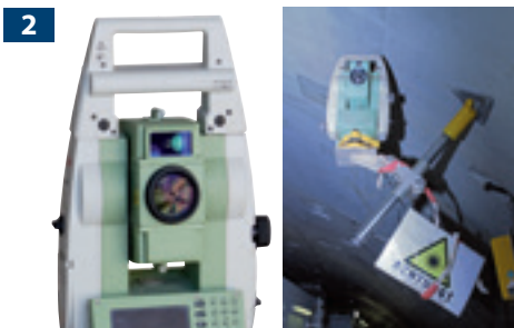
14-TK2: Überkopf-Montage im Firstbereich des Tunnels
