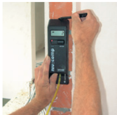
Zum Nivellieren von Boden- und Deckenpunkten eignet sich der optionale 5-teilige Tast-Stangensatz.
