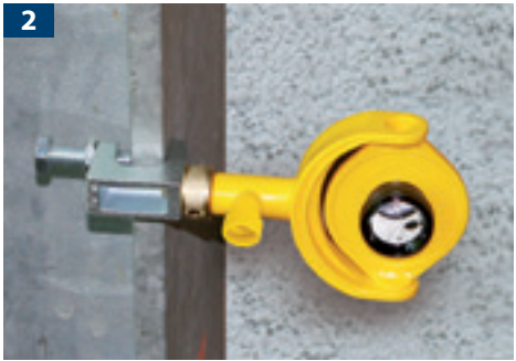
46-TK-M8 hier im Einsatz mit Adapter 11R5-W und Glasprisma 46-MP.
