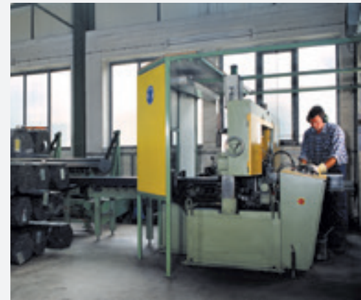
Anlagen für Vermarkungsbolzen aus Edelstahl und Messing. Die Umformwerkzeuge für Sonderaufschriften und Nägel entstehen in Eigenproduktion. Diese in Kombination mit den erstklassigen Materialien und unseren Fachkenntnissen in der Kaltumformung garantieren höchste Qualität sowie kurze Lieferzeiten.
