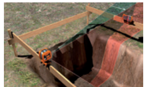
Auto-Align-Funktion (HVA und HVA2N): Auf Knopfdruck richtet sich die Laserebene automatisch auf den COMMANDER 2-Empfänger aus. Optimal für den Schnurgerüsteinsatz (siehe Seite 223) oder beim Fassadenbau bei Distanzen bis zu 50 Metern.
