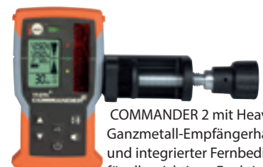
Auto-Align-Funktion (HVA und HVA2N): Auf Knopfdruck richtet sich die Laserebene automatisch auf den COMMANDER 2-Empfänger aus. Optimal für den Schnurgerüsteinsatz (siehe Seite 223) oder beim Fassadenbau bei Distanzen bis zu 50 Metern.
