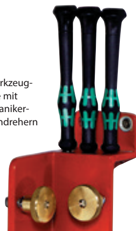
Ansicht von oben: Anlageschraubenpaar mit Kontermuttern, Führung und Halterung für Klemmkeil
