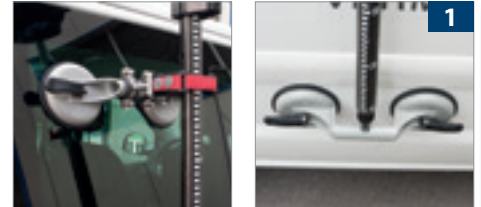
Obere Brücke mit Klemmfixhalter und Klettband | Untere Brücke
