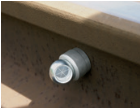
Kugelprismen-System bestehend aus einer magnetischen Kugel-Basis und dem Kugelprisma im Einsatz bei einer Gleisüberwachung.
