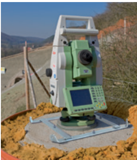
Montagerahmen von 14-WSH-P auf einem Betonpfeiler montiert.
