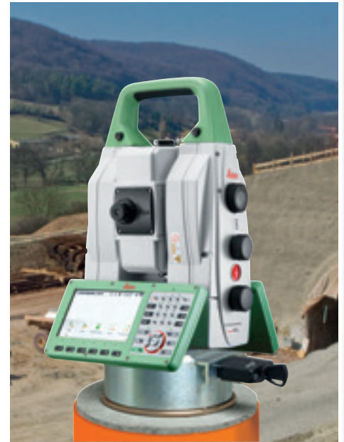
Tachylock-Ultra auf einem Betonpfeiler
