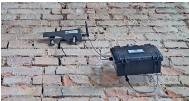
Einsatzbeispiel 6D-Sensor (S-100) mit Batteriekoffer (E-100)
