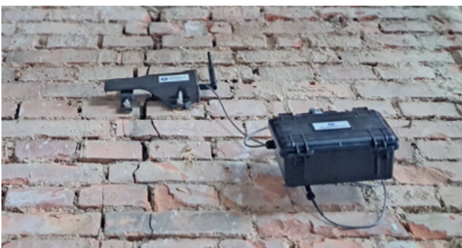
Einsatzbeispiel 6D-Sensor (S-100) mit Batteriekoffer (E-100)
