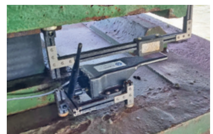
Sonderadaption 6D-Sensor an Brückenwiderlager (Preis auf Anfrage)
