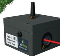
In der IX-LDS-Node sind 3-Achs-Neigungssensor und Laserdistanzmesser besonders kompakt zusammengefasst. Neben den Neigungen können so auch kontaktlos 1D-Bewegungen in beliebiger Orientierung erfasst werden. Aufgrund der simplen Installation und geringen Einbaumaße finden ODS häufig bei der Erfassung von Tunnelkonvergenzen Anwendung.
