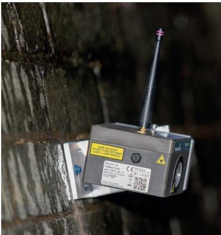
ODS-Sensor mit Rechtwinkel-Montage und Swivel Mount
