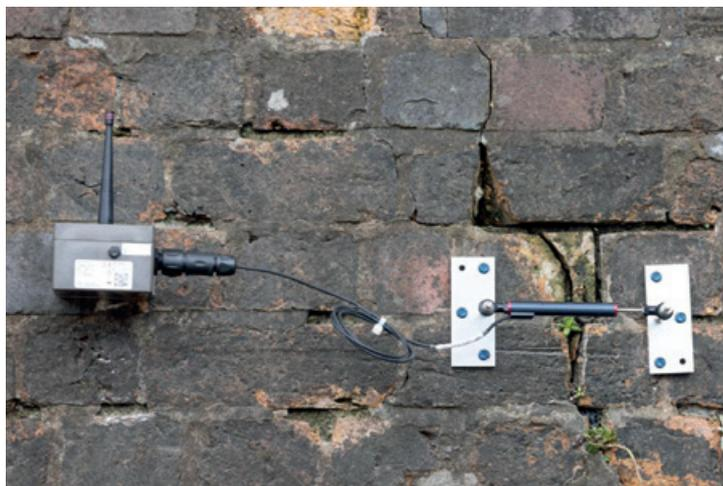
Bsp.: Einkanal Node mit Riss-Sensor Erfassung von Dehnung und Stauchung
