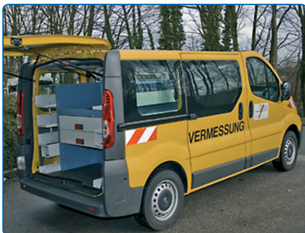
Opel Vivaro mit verstärkter Siebdruck-Bodenplatte zum Werterhalt des Fahrzeugs und zur leichteren Montage der Einrichtung, da bei einigen Fahrzeugtypen die serienmäßig vorhandenen Befestigungsmöglichkeiten sehr ungünstig für den Einbau liegen. In diesen Fällen fungiert der zusätzliche Boden auch als „Brücke“ für die Verankerung.
