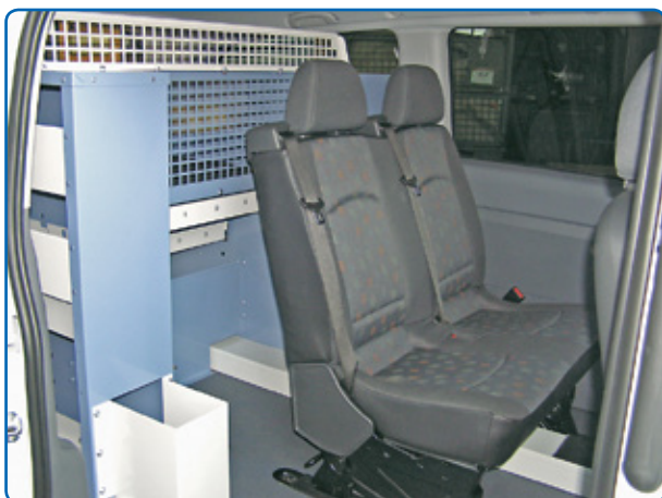
Mercedes-Benz Vito mit Heckeinrichtung classic. Hier wurde ein zusätzliches Fluchtstab-Fach eingebaut.
