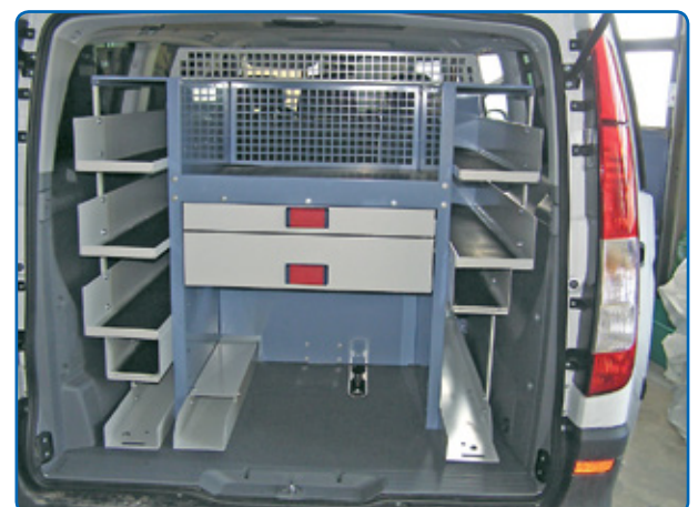
Mercedes-Benz Vito von hinten mit zusätzlichem Fach für Fluchtstäbe im Bereich des linken Seitenteils.
